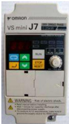
В норме светодиодный индикатор FREF должен гореть, а индикатор RUN гореть или мигать. На экране преобразователя отображается рабочая частота электродвигателя.
